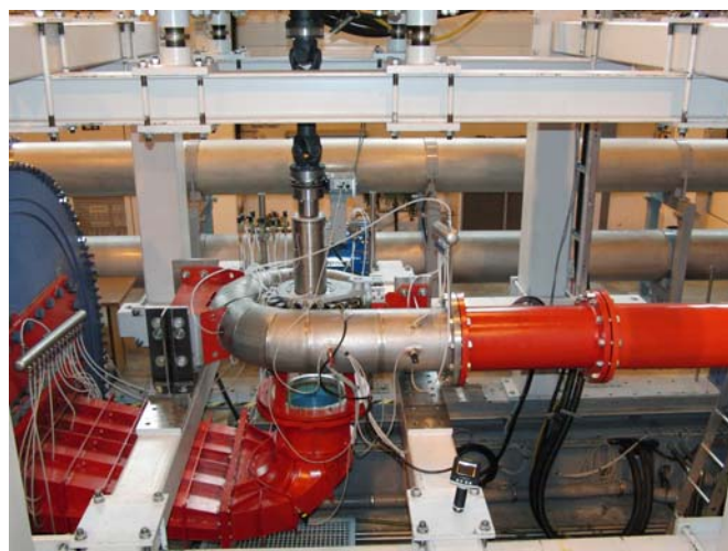
Modelové zkoušky Francisovy turbíny pro VE Sarapullo v hydraulické laboratoři ČKD Blansko Engineering
